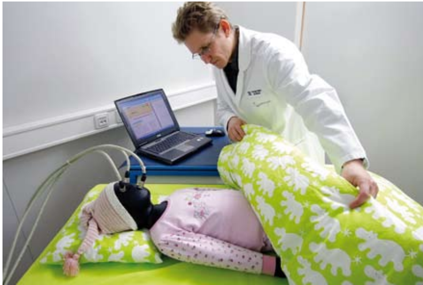
Mit dem Thermoregulationsmodell eines ca. drei Jahre alten Kindes (Charlene) wird an den Hohenstein Instituten insbesondere der Schlafkomfort von Bettwaren für Kinder untersucht und optimiert.
