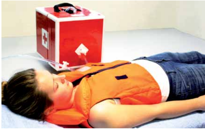
Konfektioniertes Funktionsmuster einer autarken, mobilen Hypothermie-Notfallweste mit integrierten Kühl-Pads. Foto: Hohenstein Institute
