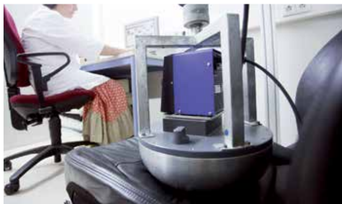
Das Polsterprüfgerät misst den Initialwärmefluss beim ersten Kontakt mit einem Autositz sowie die effektive Wärmeisolation während der Fahrt. Foto: © Hohenstein Institute
