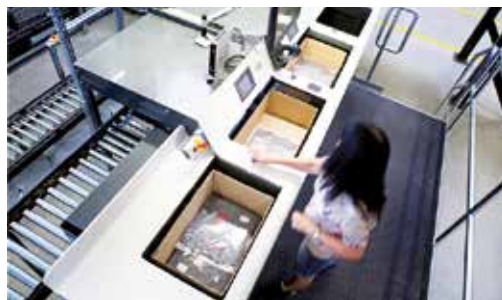
Herzstück des neuen Logistikzentrums ist ein OSR-Shuttle mit 400 000 Stellplätzen. Die Artikel kommen automatisch an den ergonomisch gestalteten Kommissionierplätzen an. Das Shuttle-Lager ist so angelegt, dass es um 60 Prozent erweitert werden kann.
