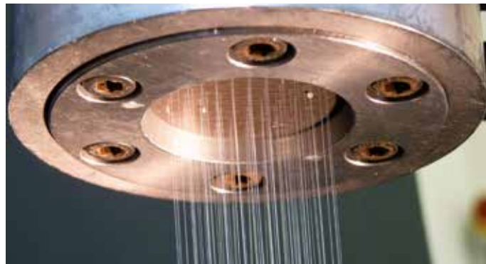
Spinnöse beim Ausspinnen von ZTA-Grünfaser Foto: ITCF Denkendorf
